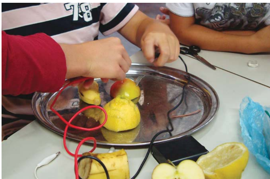
Met een stroomsterktemeter werd de stroom uit een citroen, appel en banaan gemeten
